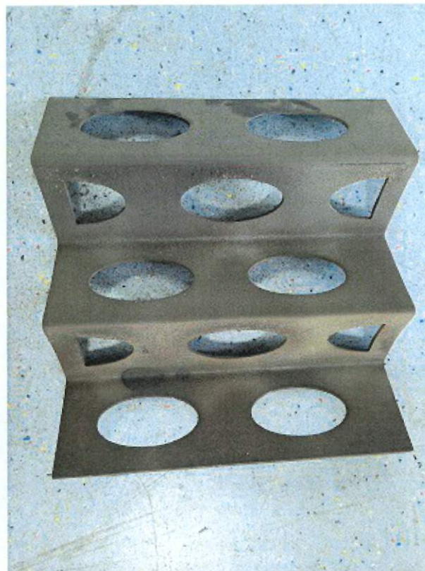
Rysunek 8 Rodzaj zastosowanych zawirowywaczy
