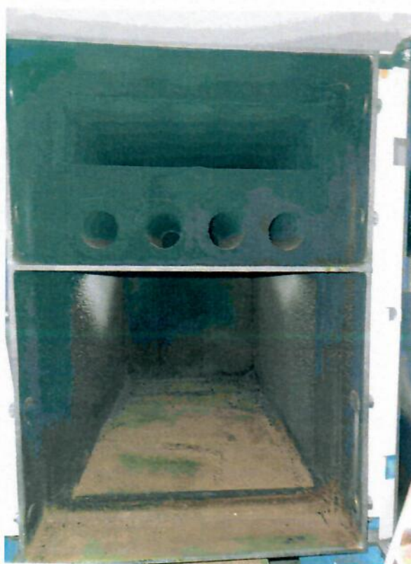
Rysunek 7 Komora spalania, wymiennika i popielnika
