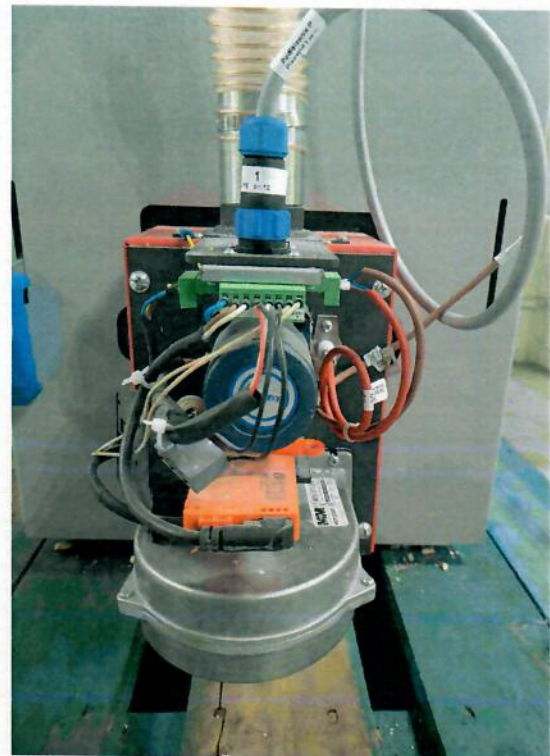
Rysunek 11 Moduł palnika z motoreduktorem i wentylatorem nadmuchowym
